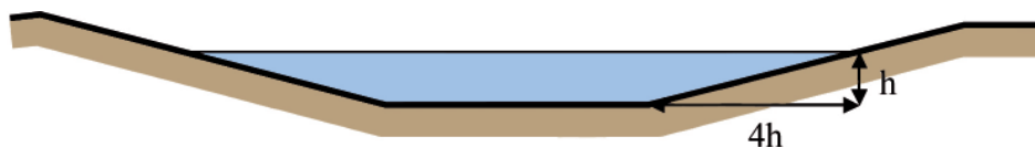
Figura 8. Perfil transversal del vertedero de máximas
